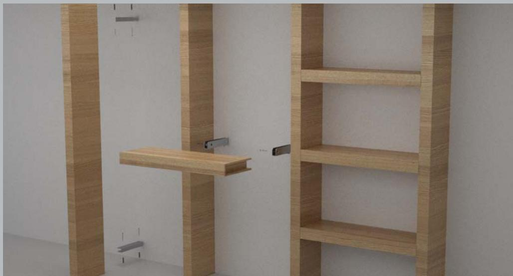
Posizionare le staffe e fissarle al muro. Inserire i fianchi e le mensole fino ad ottenere il risultato voluto.
