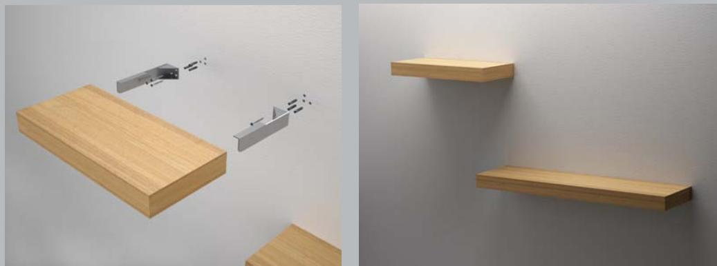
Posizionare le staffe e fissarle al muro. Inserire la mensola facendola scivolare verso il muro stesso.
