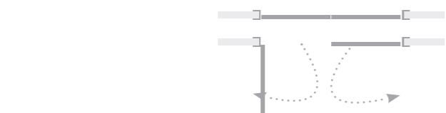
\* anta semifissa apribile all'occorrenza | semi-fixed leaf that can be opened at need | porte semi-fixe ouvrante si nécessaire | hoja semifija practicable cuando es necesario | halb feststehender Türflügel, zum Öffnen bei Bedarf | пассивная створка открывается по необходимости
